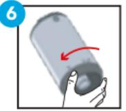
6 För att släcka apparaten vrid knappen mot vänster till OFF-läge. Låt apparaten svalna helt innan du ställer den undan.
