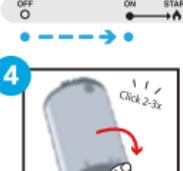
4 Vänta 5-10 sekunder och vrid därefter knappen mot höger till START-läge så att det hörs ett klick.
