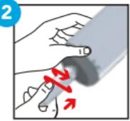
2 Ta bort locket på gaspatronen och skruva fast patronen. Skruva inte för spänt.
