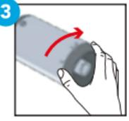
3 Vrid knappen som ligger i undre delen av apparaten mot höger till ON-läge. Gasen börjar flöda.
